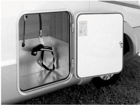
Fig. 60 : Exemple de caisson à gaz
