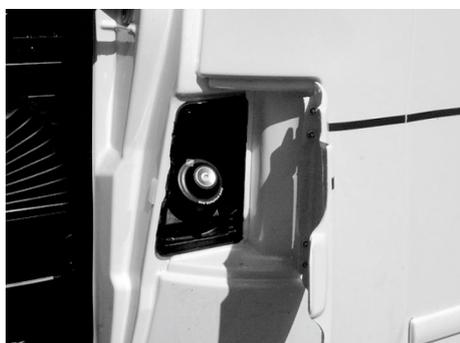
Fig. 11 : Exemple de bouchon de réservoir de carburant
