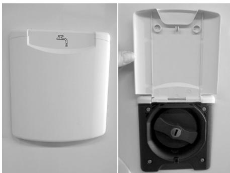
Fig. 22 : Manchon de remplissage d'eau fraîche
