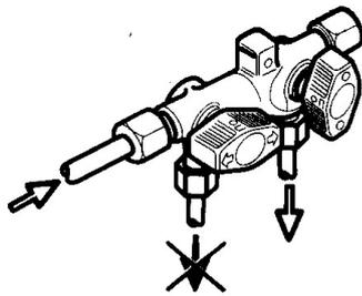
Fig. 63 : Position fermée et ouverte
