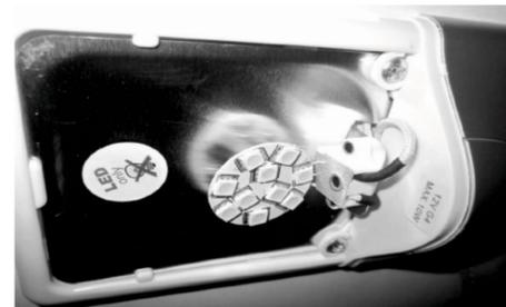
Fig. 143 : Introduire l'ampoule LED
