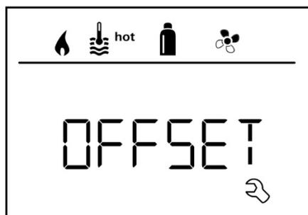
La sonde de température ambiante du chauffage raccordé peut être adaptée individuellement à la situation de montage de la sonde. Le réglage est possible en paliers de 0,5 °C dans la plage de 0 °C à -5 °C.
