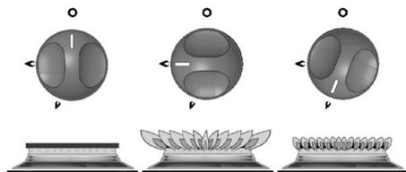
Fig. 134 : Positions des boutons : ARRÊT, grande flamme, petite flamme
