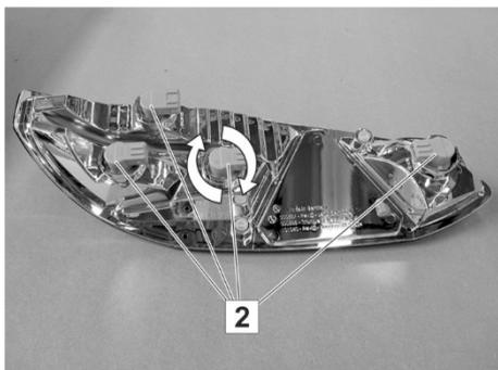
Fig. 149 : Feu arrière (face arrière)
