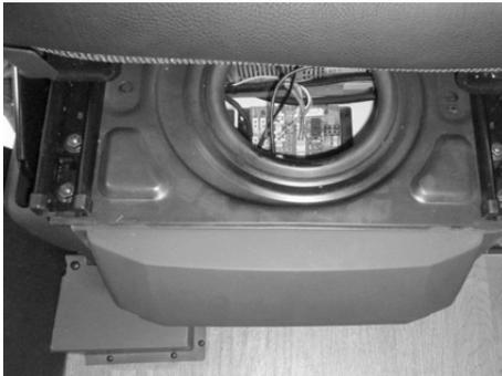
Fig. 8 : Module d'interface sous le siège du conducteur
