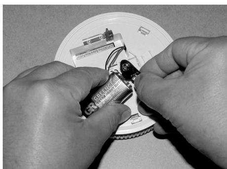
Fig. 152: Remplacer la pile
