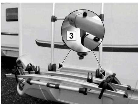
Fig. 24 : Enclencher les arrêtoirs
