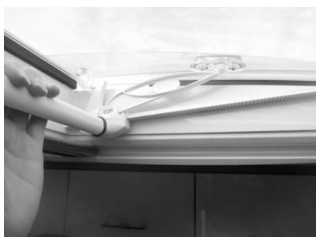
Fig. 87 : Lanterneau 400x400 mm / VisionStar 700x500 mm : utilisation
