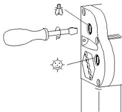
Les ressorts des stores peuvent être remis en tension à l'aide d'un tournevis.
