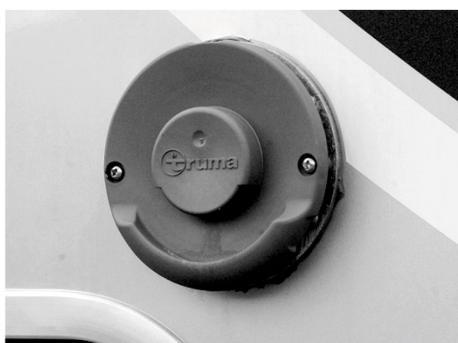
Fig. 70 : Conduit d'évacuation des gaz brûlés (sur la paroi)
