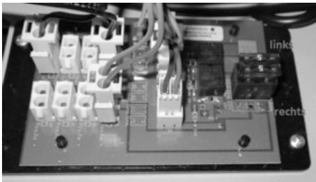
Fig. 9 : Module d'interface
