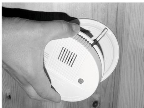
Fig. 151: Retirer le boîtier
